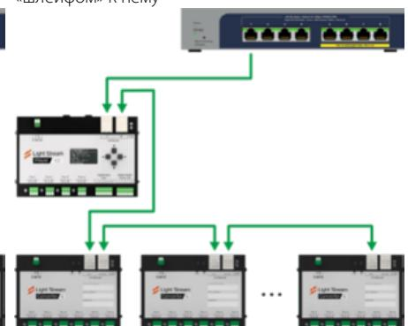
\* - если нужно будет управлять конвертерами с помощью ПО Light Stream, то ПК с подходящими сетевыми настройками нужно будет подключить во второй порт Converter, последнего в шлейфе.
